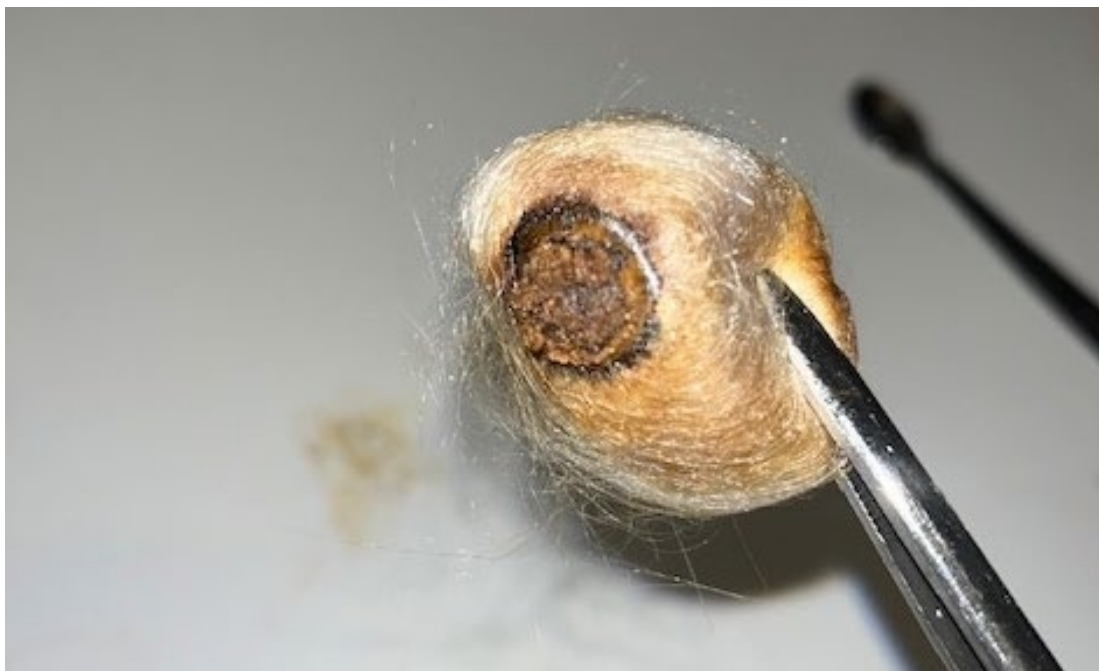
Figur 4. Aerosoler som fastnade i glasullen och gjorde att första experimentet fick avbrytas.
