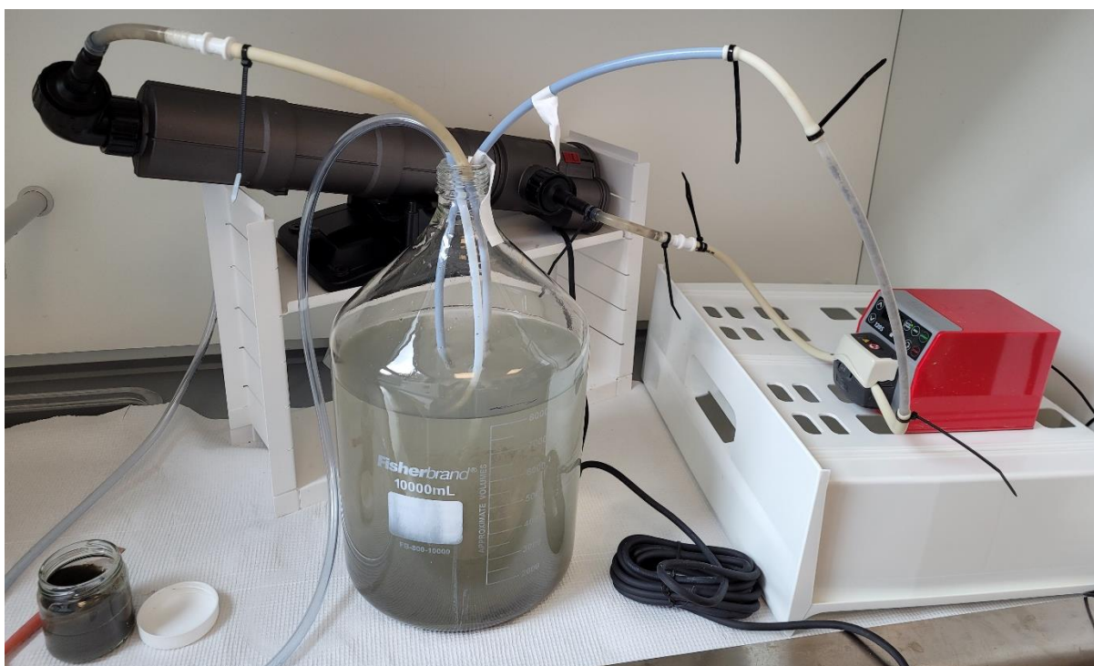
Figur 7. Experimentell uppställning för test av recirkulation av sedimentslurry genom UV-kammare.
