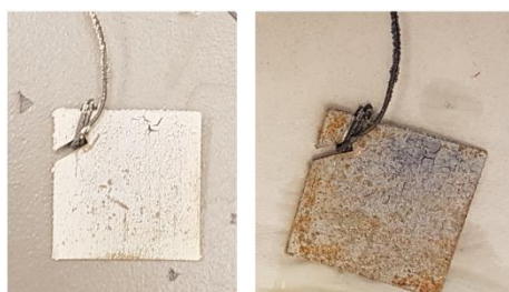
Figur 9. Reduktion av metylenblått under belysning med UV-ljus med våglängden 302 nm och intensiteten 1 mW/cm 2 . En kontroll utan elektrod och två elektroder tillverkade med elektrokemisk reduktion vid 16mA och antingen 2 eller 4 timmar testades. Till höger visas en bild på en ZnO på stål-elektrod före och efter försöket.
