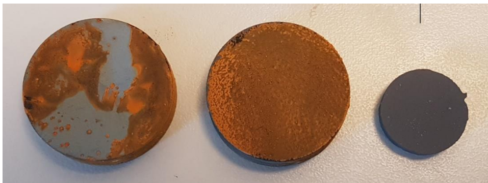
Figur 10. Två elektroder med \text{TiO}_2 på stål som uppvisar problem med korrosion (till vänster) och en elektrod med \text{TiO}_2 på titan som inte har korrosionsproblem (längst till höger).
